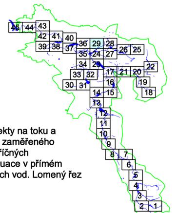
Poznámka: Délka úsečky vyznačující příčné řezy, objekty na toku a údolní profily vymezuje rozsah geodeticky zaměřeného řezu. Mimo zaměřený rozsah je terén v příčných řezech a objektech na toku vynesěn ze situace v přímém prodloužení řezu až k hranici rozlivu velkých vod. Lomený řez je označen čárkovaně.
