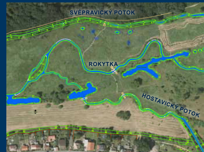
Revitalizované koryto v suchém poldru Čihadla
